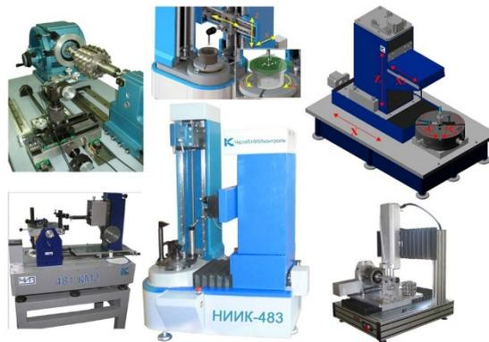
Рис. 1. Примеры выпускаемого ЗАО «ЧелябНИИконтроль» координатно-измерительного оборудования
