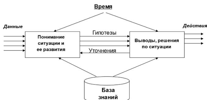
Рис. 1. Упрощенное представление модели выработки решений при ситуационном управлении
