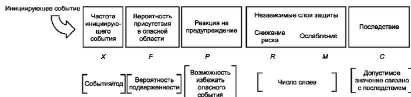
Рис. 3. Схема оценки риска по основным параметрам граф-модели риска
