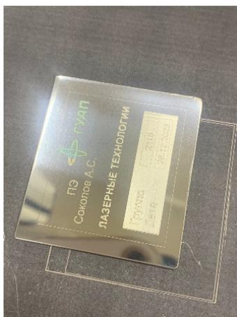
Рис. 1. Результат эксперимента и получения слоя побежалости на поверхности нержавеющей стали
