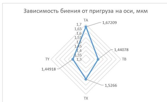
Рис. 5. Графически выведенная зависимость биения от пригруза 27,94 грамма на осях, мкм
