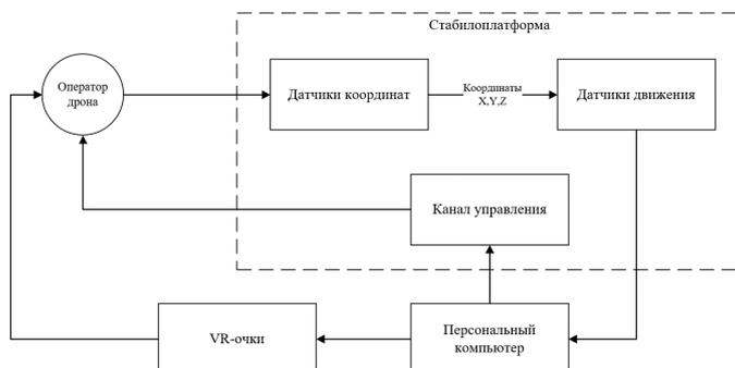
Рис. 1. Структурная схема оценки вестибулярного аппарата
