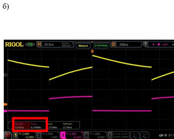
Рис. 2. Осциллограмма входного и выходного сигналов ГПИ. Моделирование (а) и макетирование (б)
