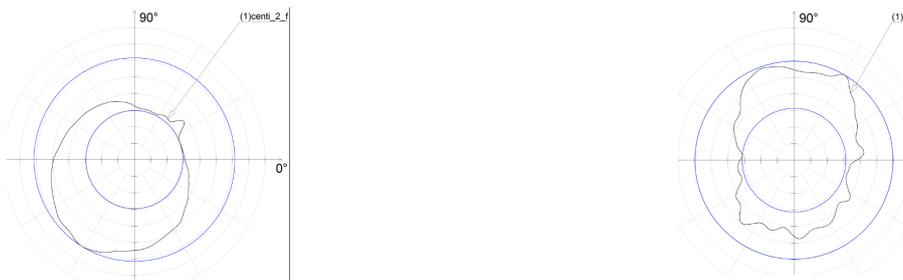
Рис. 4. Круглограмма до приклеенного груза (слева) и после наклеивания груза в 7,9 грамм микрограмм (справа) Mahr
