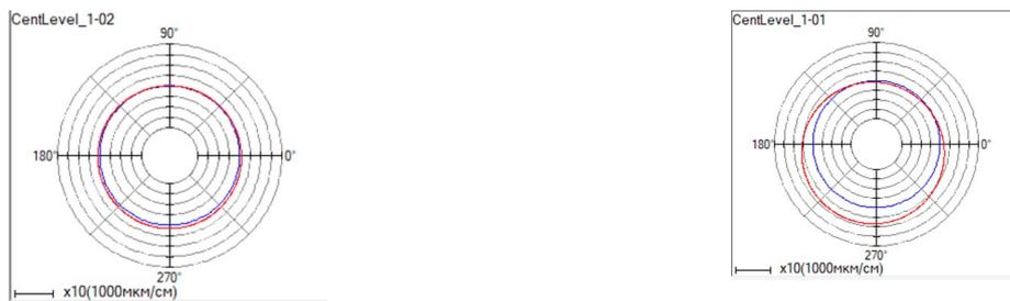
Рис. 3. Круглограмма до приклеенного груза (слева) и после наклеивания груза в 7,1 грамм микрограмм (справа) Mitutojo
