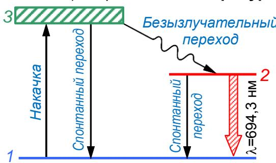
( $\text{Al}_2\text{O}_3$  с примесью (~0,03%)  $\text{Cr}^{3+}$ ) переводит атомы хрома в **возбуждённое короткоживущее состояние 3** (переход 1→3), с которого происходит безызлучательный переход в **долгоживущее (метастабильное) состояние 2** – происходит "накопление" атомов хрома на **уровне 2**.
