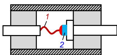
В точечных диодах  $p$ - $n$ -переход образуется в точке касания **металлического контакта 1** и **полупроводника 2** (например, в точечном германиевом диоде диффузия алюминия в  $n$ -германий образует в германии  $p$ -слой). Технология изготовления германьевого **плоскостного** диода описана выше.
