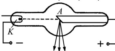
рентгеновская трубка, в которой вылетающие с катода  $K$  электроны бомбардируют анод  $A$  (антикатод), изготовленный из тяжёлых металлов (W, Cu, Pt и т. д.).
