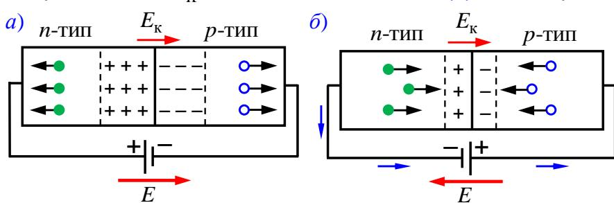
и его сопротивление возрастает – такое направление называется **запирающим (обратным)**. Если направление внешнего поля противоположно полю контактного слоя (б), то перемещение электронов и дырок приведёт к сужению контактного слоя, и его сопротивление уменьшится – такое направление называется **пропускным (прямым)**.
