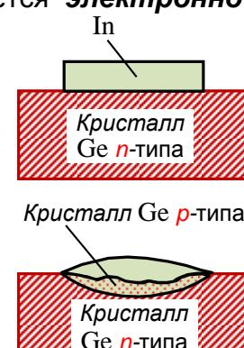
Электроны из  $n$ -полупроводника, где их концентрация выше, будут диффундировать в  $p$ -полупроводник. Диффузия дырок происходит в обратном направлении. В  $n$ -полупроводнике из-за ухода электронов вблизи границы остаётся нескомпенсированный **положительный объёмный заряд** неподвижных ионизованных донорных атомов.
