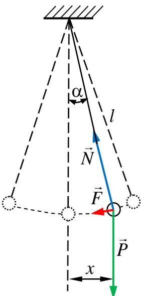
Следовательно, движение математического маятника описывается дифференциальным уравнением гармонических колебаний, то есть происходит по закону  $x = A \cdot \cos(\omega t + \varphi)$  с частотой и периодом, соответственно:
