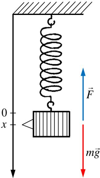
Если на маятник действует сила трения, пропорциональная скорости  $F_{\text{тр}} = -r\dot{x}$ , где  $r$  – коэффициент сопротивления, то колебания маятника будут затухающими, и закон движения маятника будет иметь вид  $m\ddot{x} = -kx - r\dot{x}$  или
