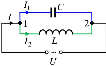
$$I_{m1} = \frac{U_m}{\frac{1}{\omega C}}, \quad I_{m2} = \frac{U_m}{\omega L}$$
