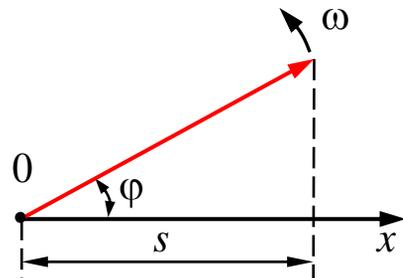
Из произвольной точки  $O$ , выбранной на оси  $x$ , под углом  $\varphi$ , равным начальной фазе колебания, откладывается вектор  $\vec{A}$ , модуль которого равен амплитуде  $A$ , рассматриваемого колебания. Если этот вектор будет *вращаться*
