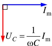
Таким образом, **падение напряжения  $U_C$  отстаёт по фазе от текущего через конденсатор тока  $I$  на  $\frac{\pi}{2}$ .**
