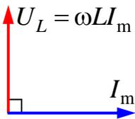
Таким образом, **падение напряжения  $U_L$  опережает по фазе ток  $I$ , текущий через катушку, на  $\frac{\pi}{2}$ .**
