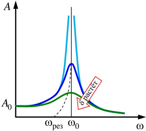
при частоте  $\omega_{рез} = \sqrt{\omega_0^2 - 2\delta^2}$ , которая назы-
