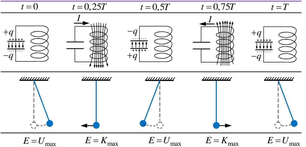
Пусть в **начальный момент времени**  $t = 0$  конденсатор заряжен зарядом  $q$ . Тогда **энергия электрического поля** между обкладками конденсатора  $W_e = \frac{q^2}{2C}$ . При замыкании конденсатора на катушку индуктивности, в контуре потечёт возрастающий ток  $I$ . **Энергия электрического поля** начнёт
