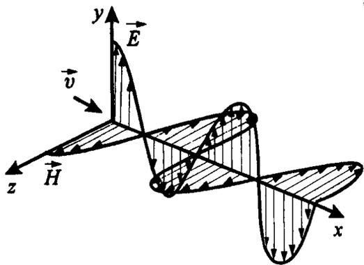
ной вектору  $\vec{v}$  скорости распространения волны, причём векторы  $\vec{E}$ ,  $\vec{H}$  и  $\vec{v}$  образуют **правовинтовую** систему. (Только  $E_y \neq 0$  и  $H_z \neq 0$ ).
