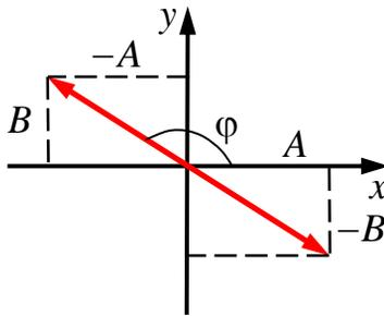
Если разность фаз равна  $\alpha = m\pi$  ( $m = 0, \pm 1, \pm 2, \dots$ ), то эллипс вырождается в отрезок **прямой**
